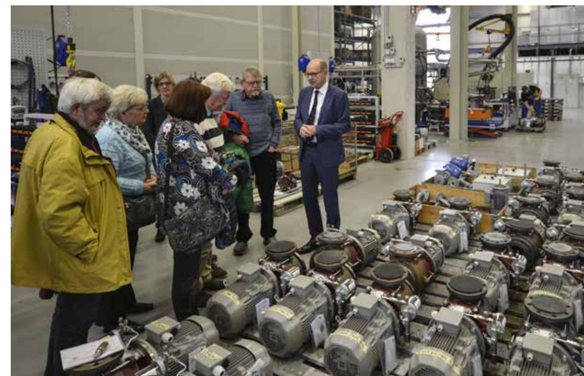
Bevor die fertig montierten Pumpen das Kieler Werk verlassen, wird jede einzeln im Funktionstest überprüft
