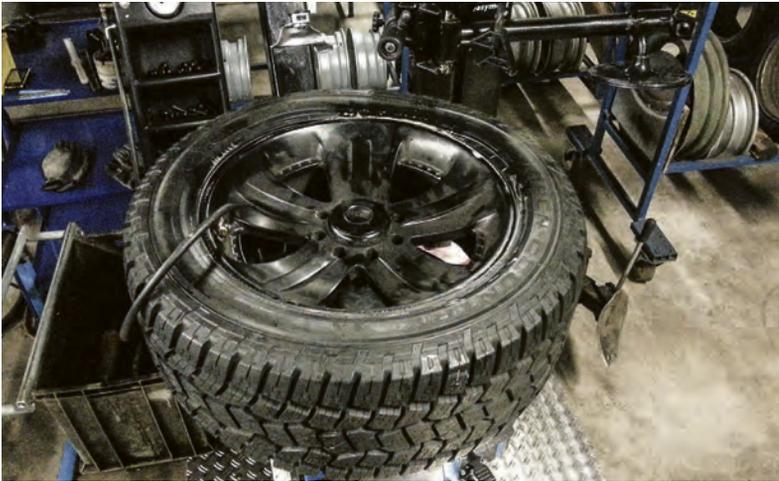
Für die Liegezeit wird höherer Luftdruck empfohlen.
