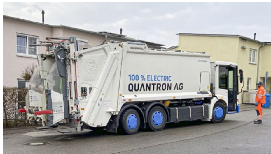
Im nächsten Jahr kommt das erste elektrisch betriebene Müllfahrzeug auf die Kieler Straßen. Es hat eine Reichweite von 150–250 Kilometern.
