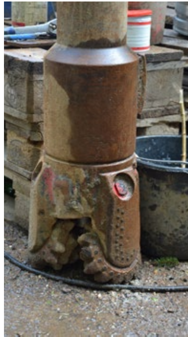
Solche Bohrköpfe bohren sich durch die Gesteinsschichten in 120 Metern Tiefe.
