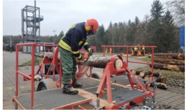
Motorsägenfortbildung: Die Station Biegesimulator simuliert umgefallene Bäume, die unter Spannung stehen und mit besonderen Techniken zerlegt werden müssen. Fotos: FF Russee
