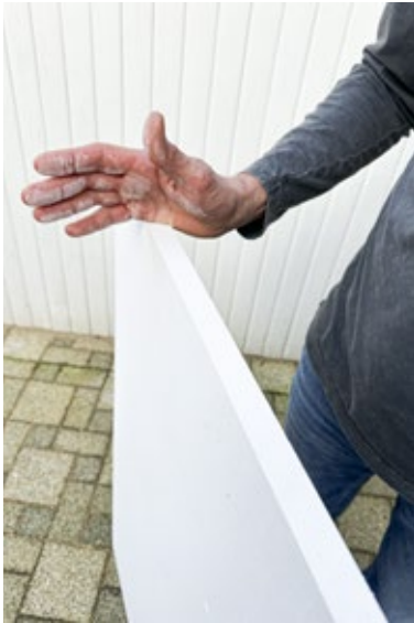
Links: So schmal ist eine Kalziumsilikatplatte. Sie dämmt und entzieht Schimmeln den Nährboden.
