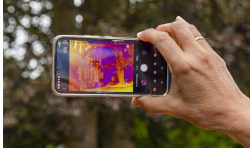
Unsichtbare Hitze: Das Thermobild der rechts abgebildeten Rotbuche macht die Temperaturunterschiede verschiedener Oberflächen sichtbar.
